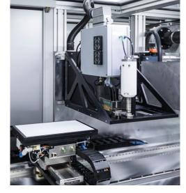
2D Inkjet-Druckversuchsstand inkl. Vakuumtisch und Härtungsmechanismen (UV, IR).
