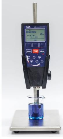
Bestimmung von Materialkennwerten, z. B. der Oberflächenspannung.
